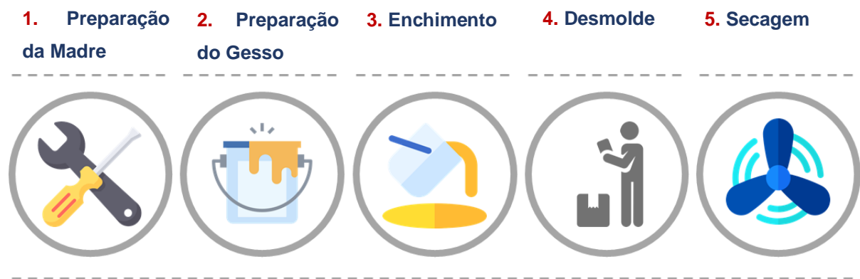
Figura 4 - Etapas da Produção de Moldes de Gesso
